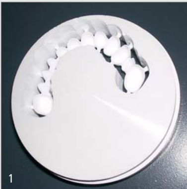
1 El puente inmediatamente después del proceso de fresado.
